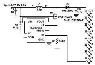
FIGURE 9. CONCEPTUAL 8 LEDS HIGH VOLTAGE DRIVER
