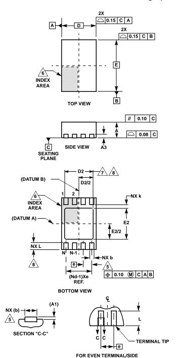
L8.2x3A 8 LEAD THIN DUAL FLAT NO-LEAD PLASTIC PACKAGE
